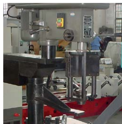
Máquina de balancear série HV com unidade de correção por furação vertical integrada
