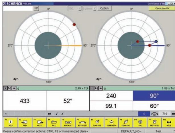
Os resultados medidos são claros e simples: indicação numérica do desbalanceamento dinâmico e vetorial com comparação de tolerância – plano 1 polar, plano 2 em componentes, posicionada no local de correção
